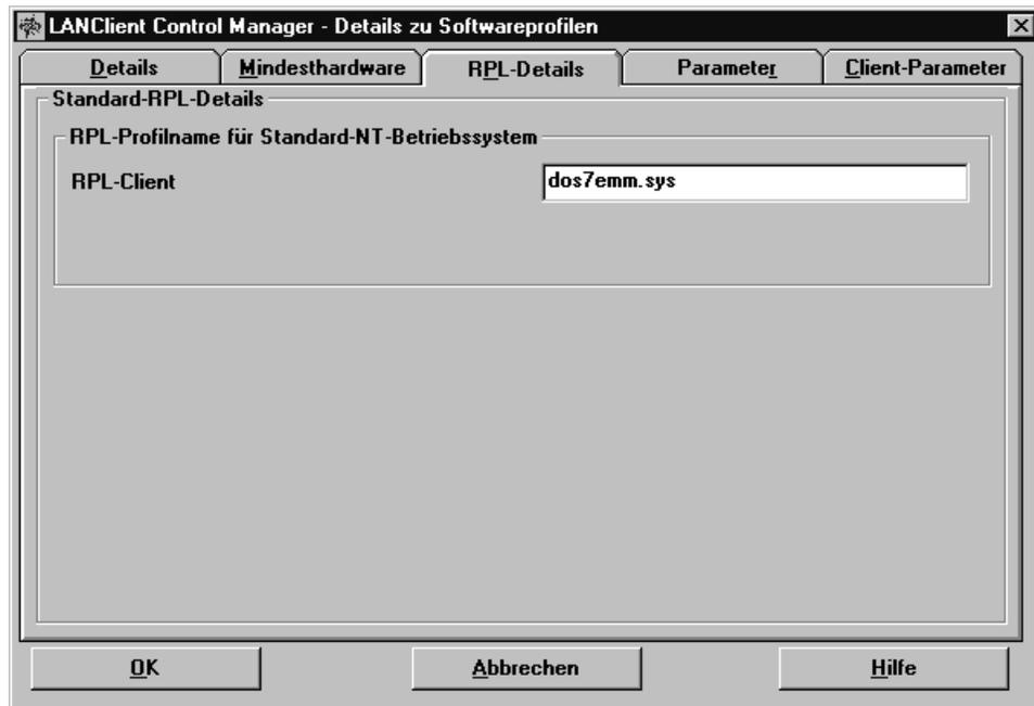
Geben Sie den Namen des Standard-RPL-Abbilds ein, oder klicken Sie auf den Knopf **Durchsuchen...**, und wählen Sie in der angezeigten Liste eins der verfügbaren Abbilder aus. Weitere Informationen zum Erstellen eines Standard-RPL-Abbilds finden Sie im Abschnitt „Standard-RPL-Abbild erstellen“ auf Seite 70.
