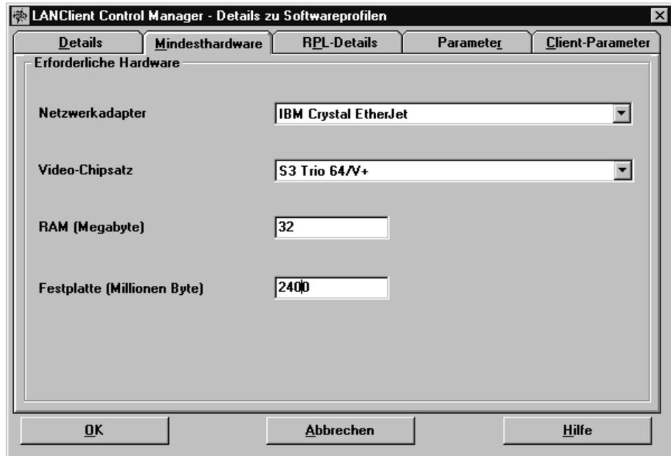
Wenn Ihr Adapter nicht in der Listet aufgeführt ist oder die diesem Softwareprofil zugeordneten Clients verschiedene Netzwerkadapter verwenden, wählen Sie den Eintrag **Beliebiger Adapter** aus. Durch diese Einstellung kann das Abbild auf jedem beliebigen Client installiert werden.
