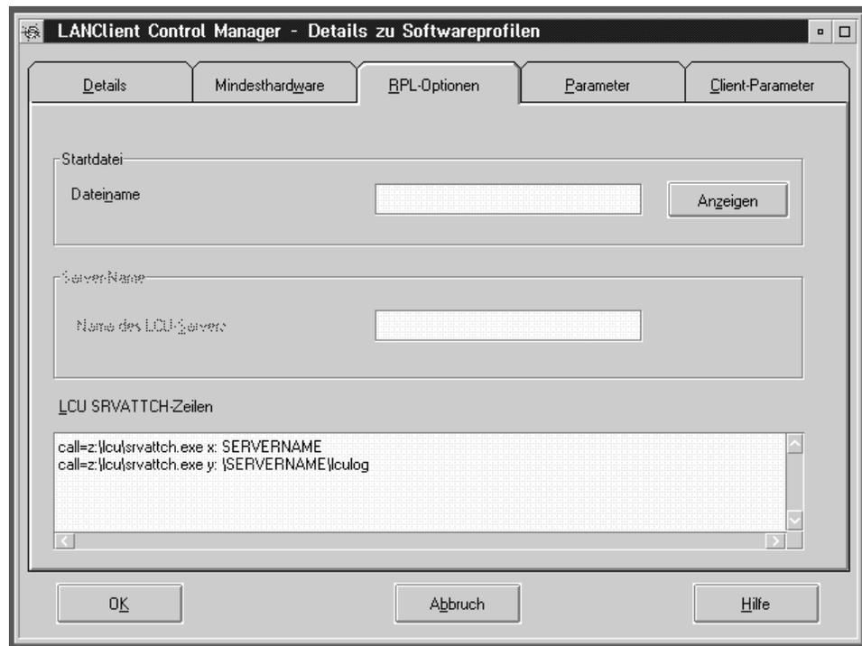
Die Datei enthält auch Zeilen mit der Anweisung SRVATTCH. Diese Zeilen werden beim Booten zur Datei CONFIG.SYS hinzugefügt. Editieren Sie diese Zeilen wie folgt:
