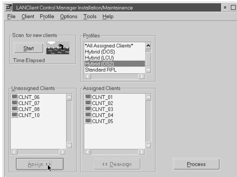
Einen von LANClient Control Manager erkannten neuen Client können Sie einem Softwareprofil zuordnen. Jedem Profil ist ein *Abbild* (eine Softwaregruppe) auf dem Server zugeordnet. Wenn Sie einen Client einem Profil zuordnen und den Knopf *Verarbeiten* anklicken, führt der Client bei seinem nächsten Start eine der nachstehend genannten Aktionen aus.
