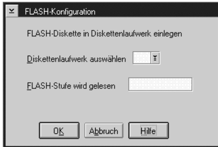
6. Wählen Sie **Konfiguration** aus. Im Verzeichnis *LCCM-Installationsverzeichnis\CLNTFILE\BIOS* wird ein neues Verzeichnis mit dem Namen der FLASH-Version erstellt, in das der Inhalt der Diskette kopiert wird.
