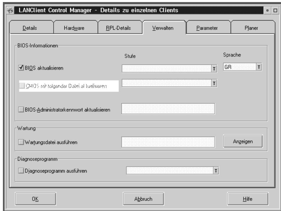
Wenn Sie eins der Felder *Aktualisieren* oder *Ausführen* auswählen, wird beim nächsten Starten des Clients nicht das Hybrid-RPL-Boot-Programm ausgeführt und auch kein Standard-RPL-Abbild heruntergeladen, sondern die ausgewählte Prozedur ausgeführt. Auf der Seite "Wartung" sind folgende Felder verfügbar:
