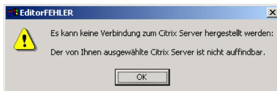
Stellen Sie zur Lösung des Problems fest, welcher Server der ICA-Master-Browser ist, indem Sie Qserver auf einem der Citrix Server in dem Subnetz ausführen, zu dem Sie eine Verbindung herstellen möchten.
