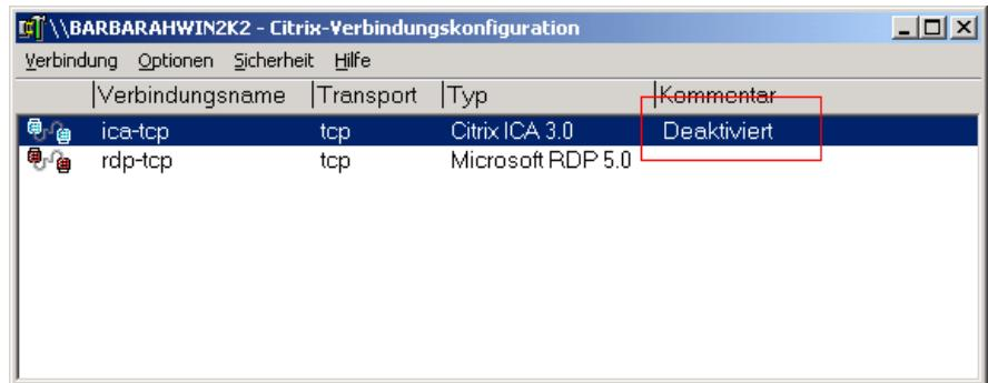
Damit ein ICA-Client eine Clientverbindung herstellen kann, muss dieser einen Socket auf TCP-Anschluss 1494 in Richtung Server sowie den Anschlüssen ab 1023 aufwärts in Richtung Client öffnen. Stellen Sie sicher, dass die Socket-Verbindungen dieses Typs zu den betreffenden Ports nicht durch einen Router oder einen Firewall blockiert werden. Gehen Sie folgendermaßen vor, um herauszufinden, ob eine Portblockade existiert.
